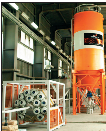
Rys. 2. Aktywator magnetyczny Wapeco (fot. Michał Cwiakała)
