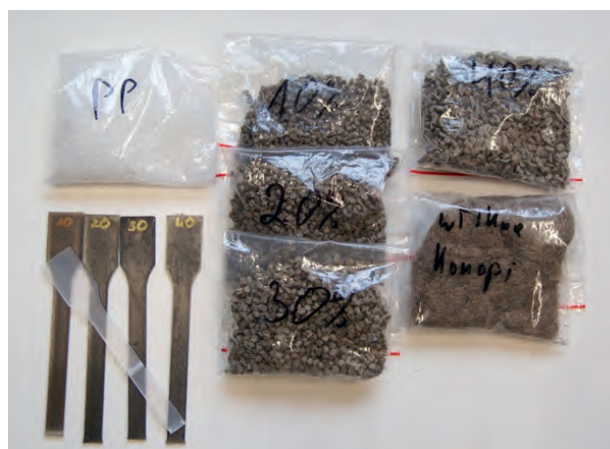
Fot. 4. Granulaty oraz wypraski kompozytów na bazie PP z dodatkiem włókien z polskich konopi (fot. ©ARC-Nucléart)
