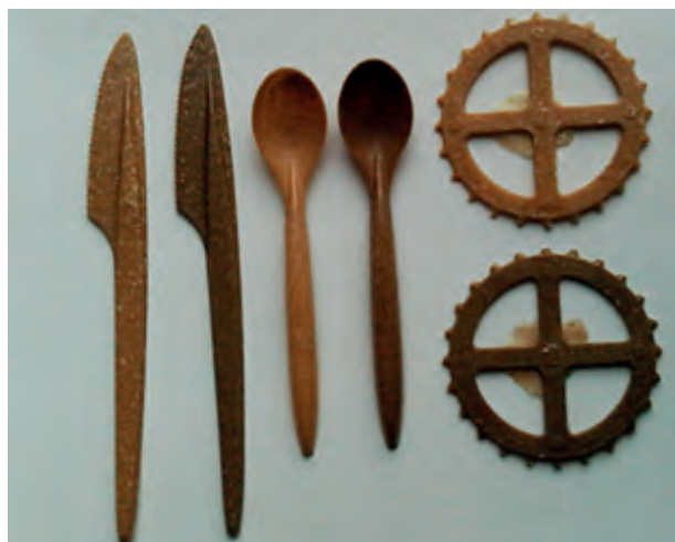
Fot. 3. Wyroby gotowe po uformowaniu: noże, łyżeczki, wypraska (40 % ścieru drzewnego, 60 % PP) (fot. ©ARC-Nucléart)
