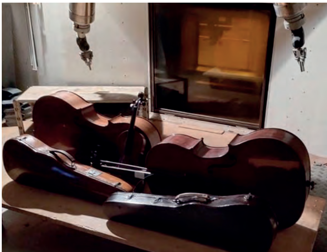
Fot. 1. Instrumenty muzyczne i futerały poddawane radiacyjnej konserwacji promieniowaniem gamma w o ARC-Nucléart w Grenoble (fot. o ARC-Nucléart)
