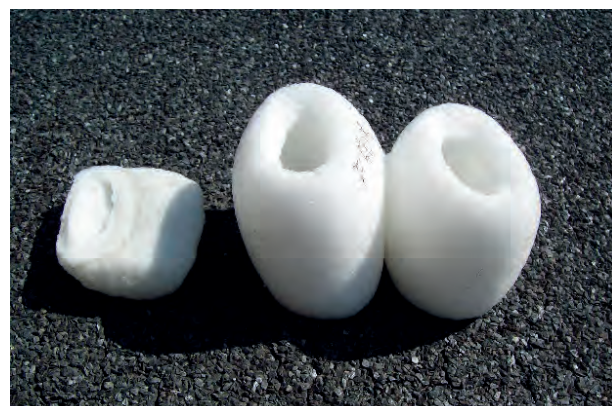
Fot. 2. Przykład wpływu radiacyjnego sieciowania na wzrost termicznej odporności polietylenowych pianek. Pierwsza próbka nie była radiacyjnie niemodyfikowana następnie napromieniowano dawką 50 kGy w azocie i powietrzu (fot. ©ARC-Nucléart)
