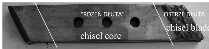
Fig. 4. Element after surface treatment [L. 8] Rys. 4. Element po wykonanej obróbce powierzchniowej [L. 8]
