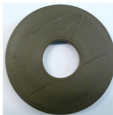
Rys. 1. Próbki paliwa raketowego poddane przyspieszonemu starzeniu:
