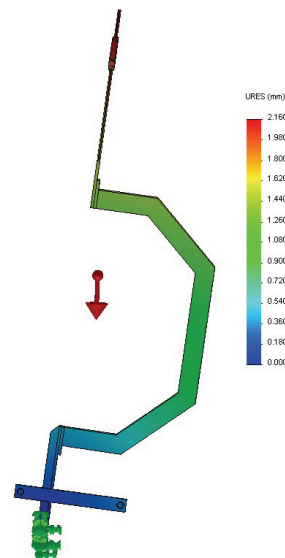
Rys. 16. Wyniki uzyskane z symulacji przemieszczeń poszczególnych punktów elementów przyrządu zamocowanego na końcu przyrządu pomiarowego od strony przeciwnej do zespołu pomiarowego pionowo zespołem pomiarowym do góry, wariant B przekroju kabłąka [opracowanie własne]
