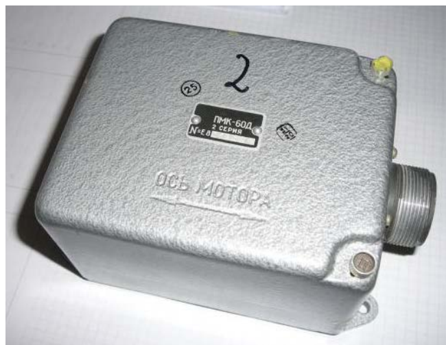
Fot. 3. Programator PMK-60D oznaczony symbolem 2
