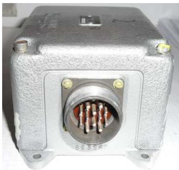
Fot.1. Złącze SZ1 programatora PMK-60D
