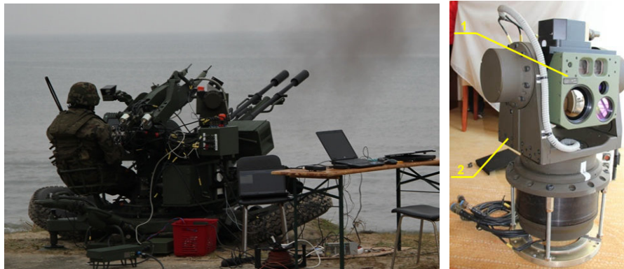
Rys. 1. Ogólny widok badanego zestawu oraz głowicy: 1 – część wahliva głowicy; 2 – część obrotowa głowicy
