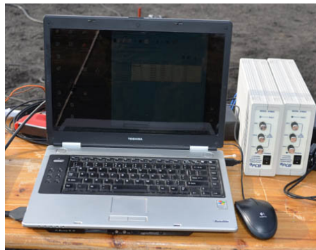
Rys. 5. Komputer przenośny z kartą pomiarową Daq/216B i oprogramowaniem rejestrującym DaqView
