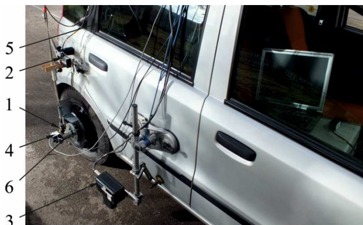
Rys. 6. Obiekt badań z zamontowaną aparaturą pomiarową
