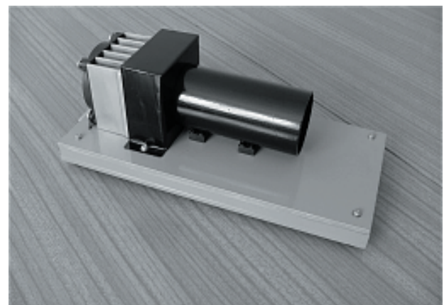
Rys.3. Widok wykonanego źródła światła z matrycą diod SLED Fig.3. View of designed light source with SLED array
