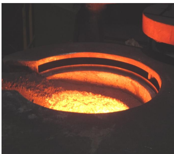
Rys. 2. Piec indukcyjny zasilany z transformatora 670 kVA
