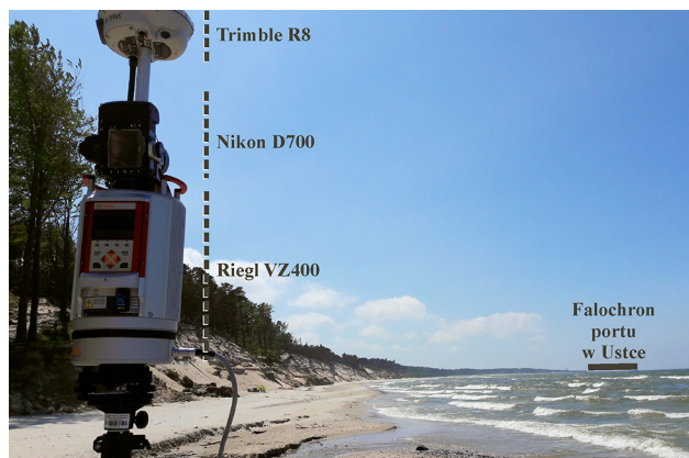
Ryc. 6. Składowe systemu naziemnego skaningu laserowego (fot. J. Frydel, 2016)
