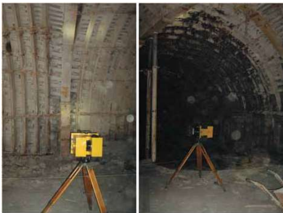
Rys. 15. Stanowisko pomiarowe na skrzyżowaniu: skanowanie w płaszczyźnie portalu (lewa) i w płaszczyźnie wspornika (prawa)
