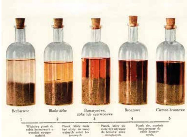
Rys. 2. Połowy magazyn cementu (z lewej) Rys. 3. Klasyfikacja czystości piasku wg zabarwienia roztworu (z prawej)
