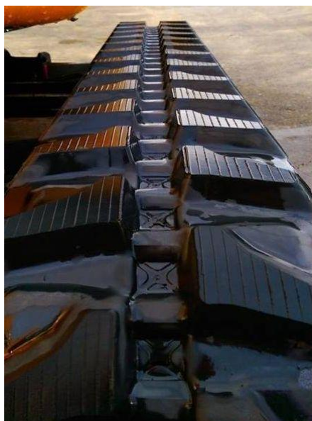
Rys. 6. Gąsienica elastomerowa Nr 1, próbka nieeksploatowana. Na powierzchni brak pęknięć i uszkodzeń, krawędzie bieżnika są ostro zakończone, a ścianki segmentów jednolite, widoczne pozostałości procesu produkcyjnego w postaci liniowych zgrubień.
