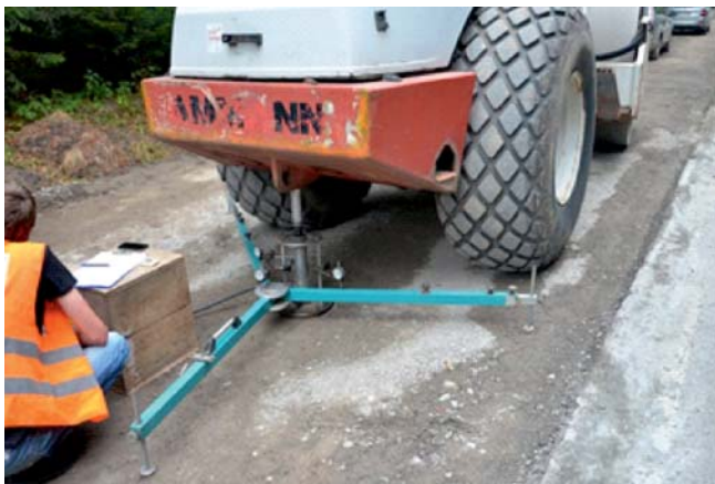
Fot. 1. Pomiar nośności i zagęszczenia podbudowy a) płytą statyczną (VSS) b) płytą dynamiczną (DW nr 752, odcinek Św. Katarzyna - Podgórze, 2015 r.)
