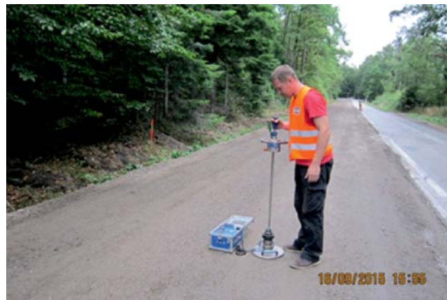
Fot. 1. Pomiar nośności i zagęszczenia podbudowy a) płytą statyczną (VSS) b) płytą dynamiczną (DW nr 752, odcinek Św. Katarzyna - Podgórze, 2015 r.)
