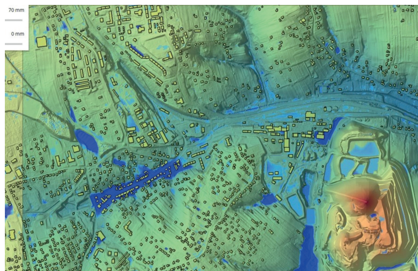
Ryc. 1. Identyfikacja depresji terenowych (miejsc zagrożenia powodziowego) w obrębie centrum miasta Rydułtowy; źródło: opracowanie własne z wykorzystaniem SCALGO Live
