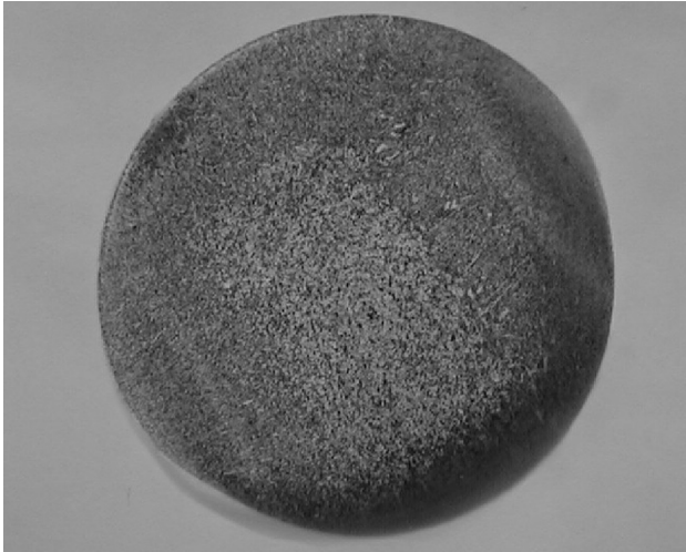
Rys. 6. Rozkład siarki na przekroju poprzecznym śruby – odbitka Baumanna [opracowanie własne]
