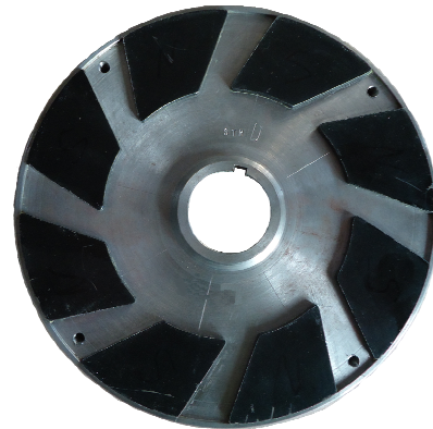
Rys. 5. Model wykonanego wirnika silnika tarczowego TORUS S-NS
