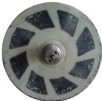
Rys. 2. Model wykonanego wirnika silnika tarczowego z wirnikiem wewnętrznym
