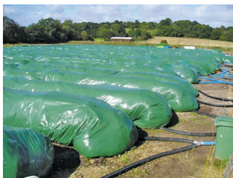
Ryc. 2. Zdjęcie reprezentujące technologię rękawową bez przerzucania i nawilżania
