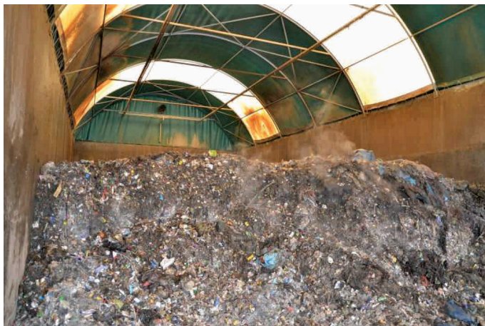
Ryc. 7. Wnętrze bioreaktora reprezentującego technologię zamkniętą z aktywnym napowietrzaniem i nawilżaniem
