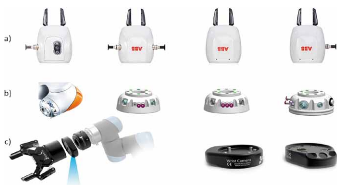
Rys. 27. Przykłady konstrukcji kiści robotów kolaboracyjnych firmy: a) ABB; b) KUKA; c) ROBOTIQ – dedykowane do robotów firmy Universal Robots
