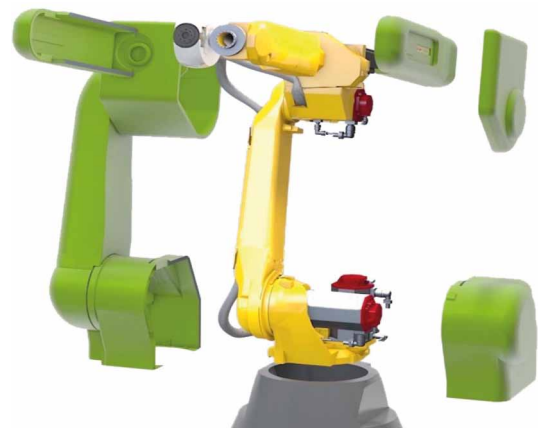
Rys. 26. Konstrukcja robota kolaboracyjnego CR-35iA firmy FANUC
