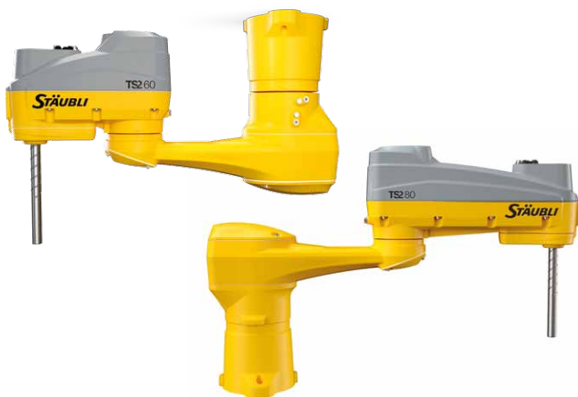
Rys. 5. Nowa rodzina robotów SCARA firmy Staubli obejmuje cztery modele: TS2-40, TS2-60, TS2-80 oraz TS2-100. Każdy charakteryzuje: zamknięta konstrukcja, całkowicie hermetyczna obudowa (której połączenia ukryte są wewnątrz konstrukcji, pod cokołem robota)
