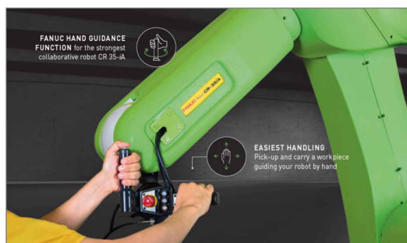
Rys. 28. Konstrukcje modułu dedykowanego do uczenia robotów kolaboracyjnych firmy FANUC
