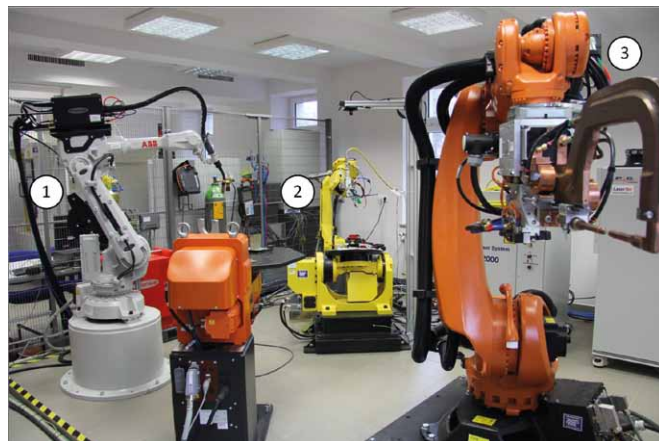
Rys. 3. Zrobotyzowane stanowiska z sześćoosiowymi robotami:
