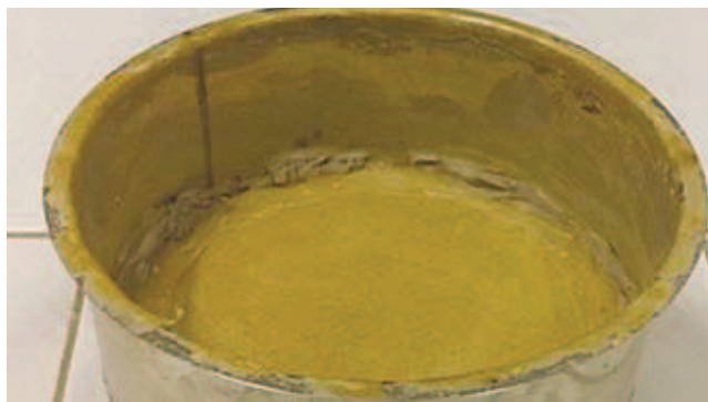
Rys. 13. Próbką ziemi w trakcie badania przepuszczalności pary wodnej
