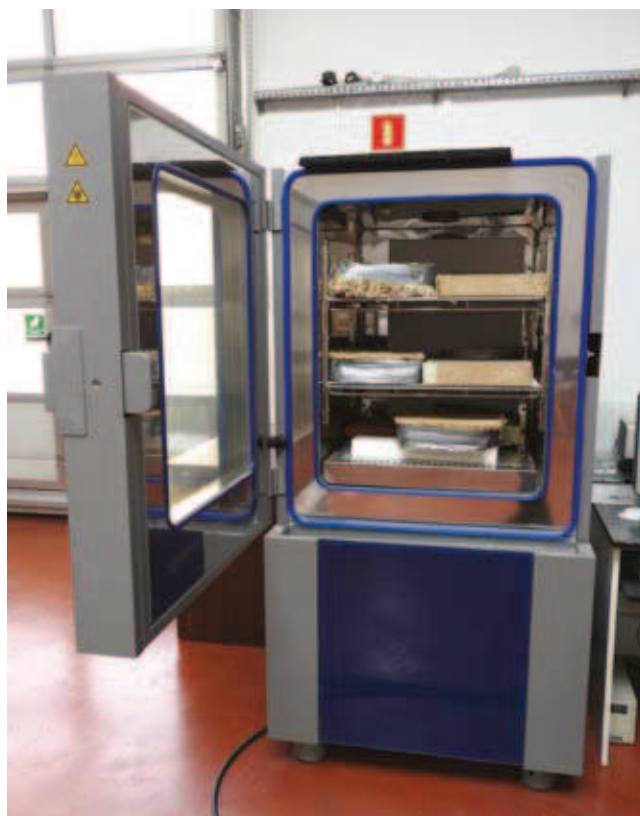
Rys. 2. Próbkę w komorze klimatycznej przed ich sezonowaniem do stałej masy
