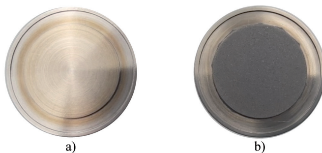
Fig. 4. Working surface of the upper plate of the plate-plate system: a) standard (PP), b) sandblasted (PPS) Rys. 4. Powierzchnia robocza górnej płytki układu płytka-płytki: a) standardowa (PP), b) piaskowana (PPS)
