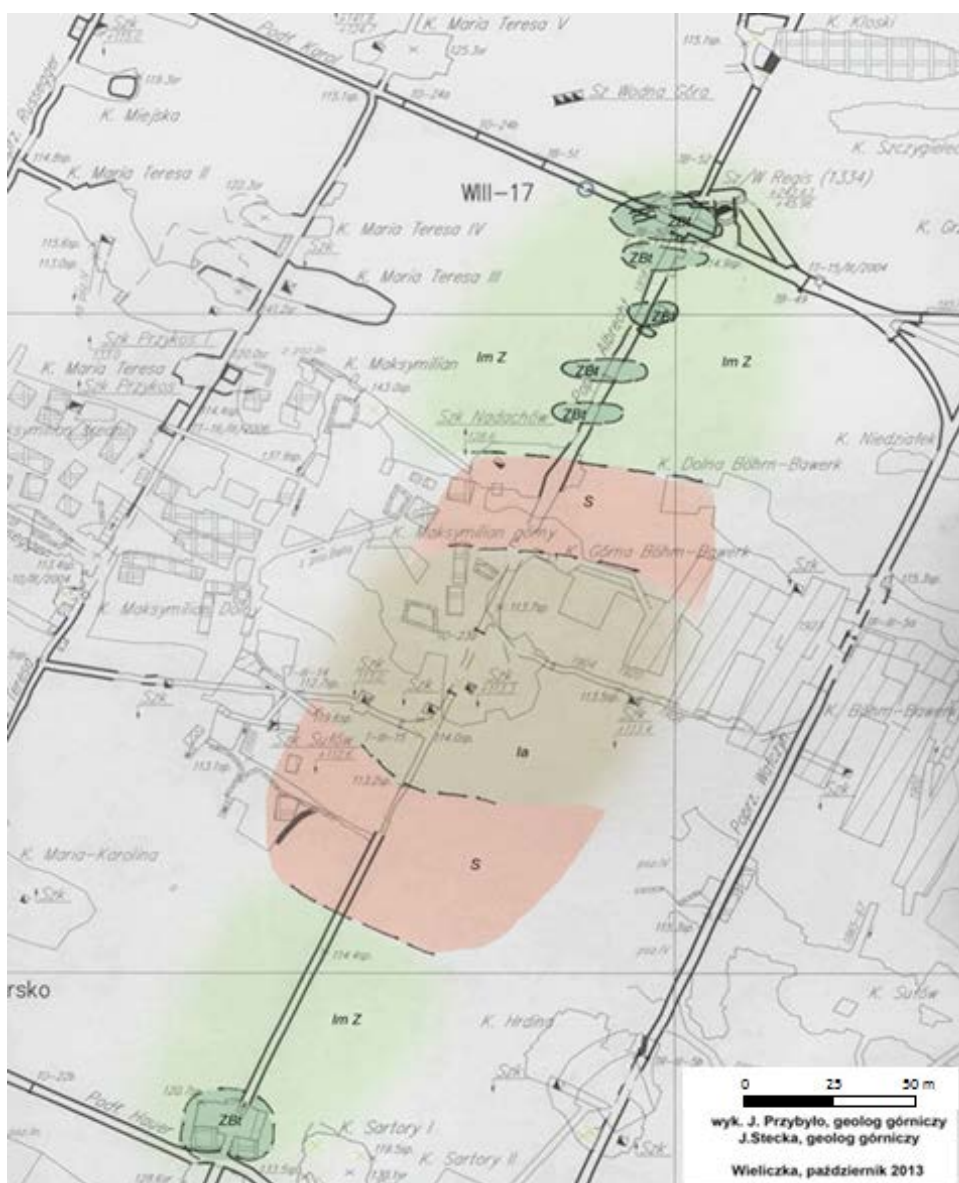
Ryc. 1. Budowa geologiczna górotworu w najbliższym otoczeniu poprzeczni Albrecht [1].
