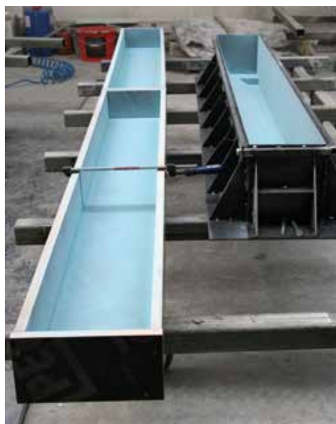
Fot. 6. Stalowa forma pokryta preparatem opóźniającym wiązanie cementu
