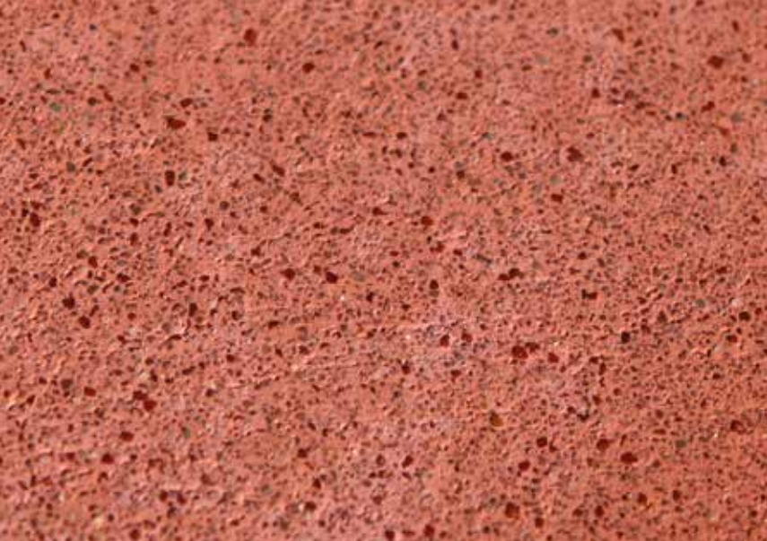
Fot. 5. Powierzchnia okładziny GRC piaskowanej kwarcytem o średnicy < 1\text{ mm}
