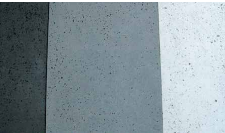
Fot. 1. Płyty elewacyjne barwione czarnym pigmentem, różne dawkowanie
