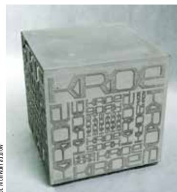
Fot. 11. Bryła ze strukturalnie formowaną powierzchnią, ścianki o grubości 2 cm
