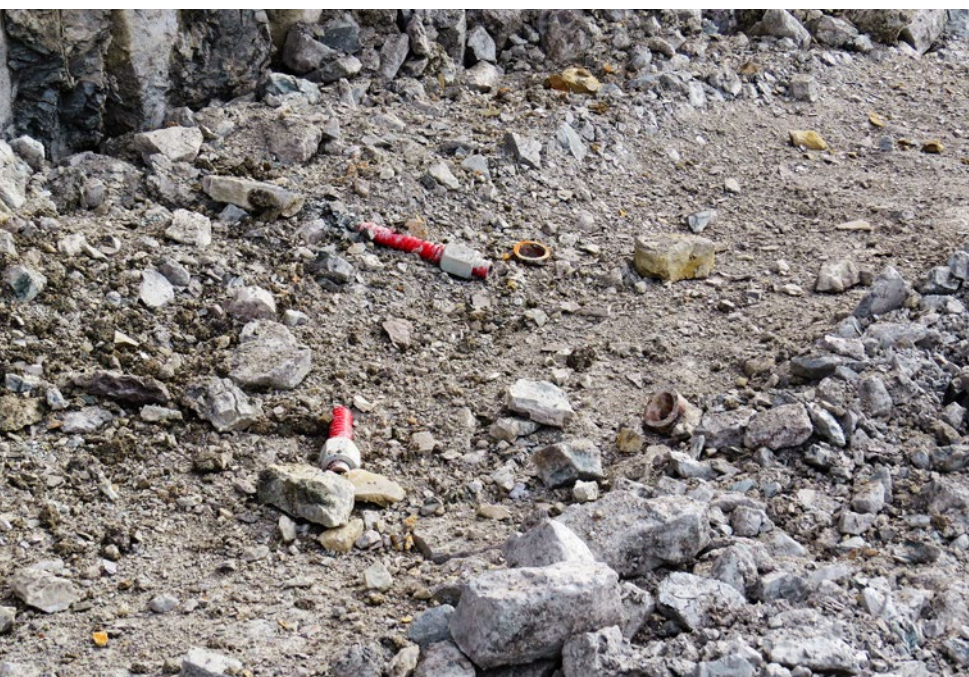
Zachowanie stali nienormatywnej trudno przewidzieć – awaria spowodowana zerwaniem żerdzi mikropali kotwiących
