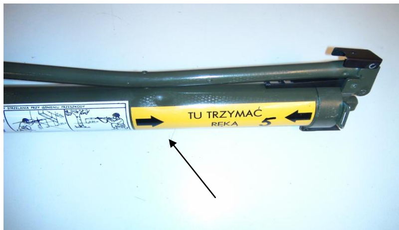
Zdj. 9. Wgniecenie w ścianie wyrzutni granatnika RPG-76 uniemożliwiające płynne wysunięcie z niej pocisku
