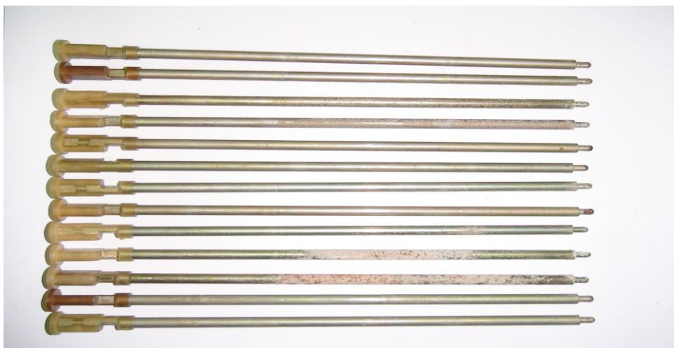
Zdj. 7. Skorodowane iglice z granatników RPG-76
