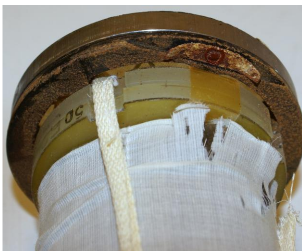
Zdj. 8. Korozja na stykach elektrycznych ładunku startowego PG-9
