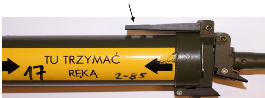
Zdj. 6. Zablokowana płytka celownika w granatniku RPG-76
