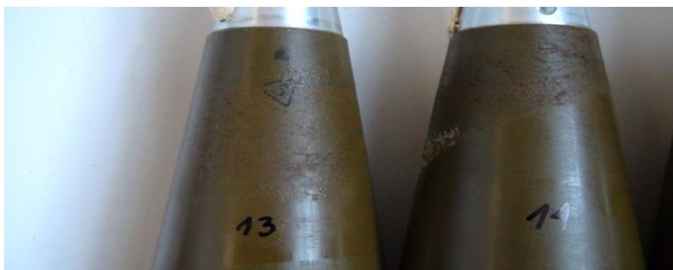
Zdj. 5. Punktowe ogniska korozji na głowicy pocisku OG-9
