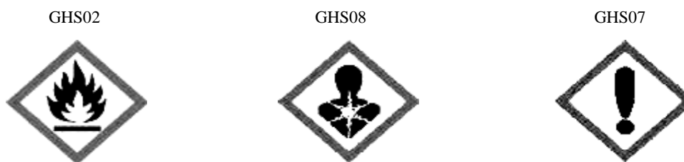
Rys. 1. Kody haseł ostrzegawczego: „Niebezpieczeństwo”. Piktogramy określone w załączniku do rozporządzenia WE 1272/2008 (CLP) mają czarny symbol na białym tle z czerwonym obramowaniem, na tyle szerokim, aby było wyraźnie widoczne
