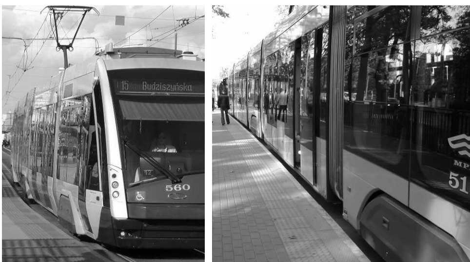
Rys. 10. Oryginalny (po lewej) i zmodyfikowany (po prawej) kształt nadwozia tramwaju Solaris Tramino. Modyfikacja kształtu pozwoliła zbliżyć podłogę pojazdu do peronu
