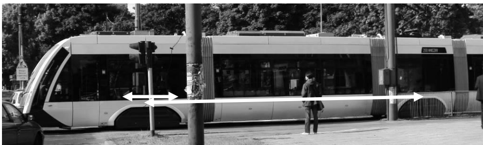
Rys. 6. Długości bazowe dla członu wózkowego (krótszy) i członu wiszącego (dłuższy) tramwaju Solaris Tramino (podobnie dla większości tramwajów Pesa czy dla tramwaju Moderus Gamma)
