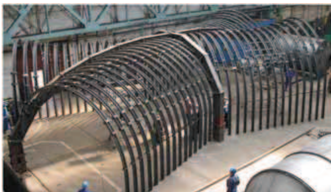
Rys. 18. Obudowa skrzyżowania o różnych gabarytach Fig. 18. Support of junctions with various dimensions
