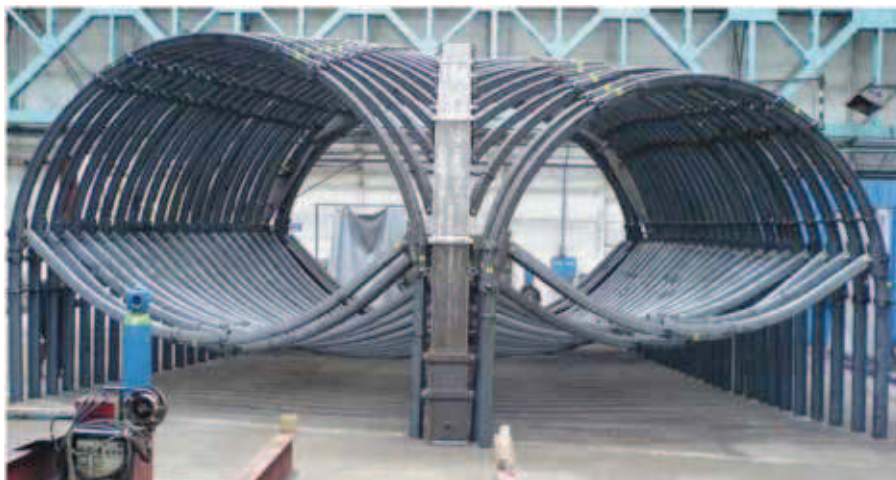
Rys. 12. Obudowa odgałęzienia R52 w trakcie montażu próbnego. Spągnice podniesione w stosunku do planowanego usytuowania w wyrobisku dla umożliwienia montażu próbnego.
