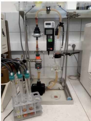
Rys. 1. Prototypowe stanowisko badawcze do oceny wpływu metali na stabilność oksydacyjną paliw do silników o zapłonie samoczynnym
