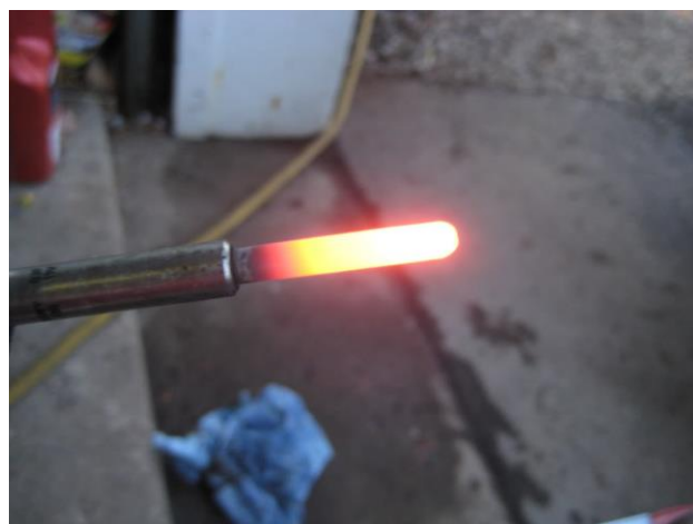
Rys. 4. Świeca żarowa rozgrzana do czerwoności
