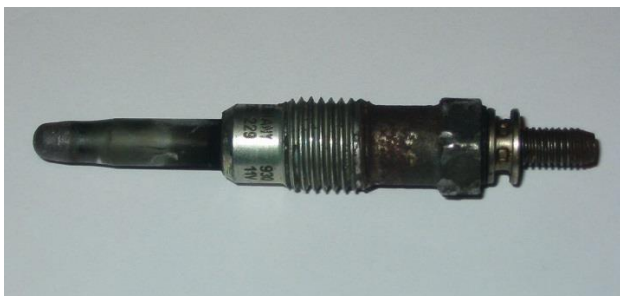
Rys. 2. Świeca żarowa z silnika turbo diesla
