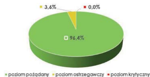
Rys. 6. Graficzne przedstawienie ogólnego stanu nawierzchni północnej jezdni autostrady A4 od km 193+965 do km 222+000 [%]
