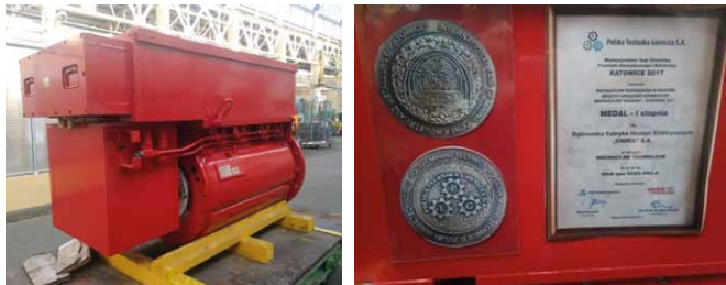
Rys. 13. Silnik zintegrowany z przełącznikiem częstotliwości SG3Fz 450L-4A 500 kW 1140 V
