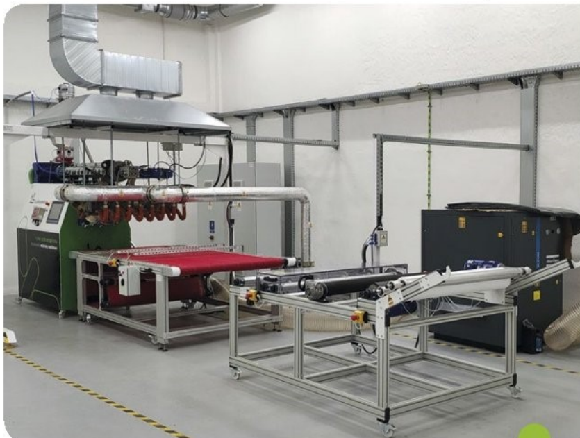
Ciąg technologiczny do produkcji włókniny filtracyjnej w technologii melt blown wykorzystywanej do produkcji maseczek
