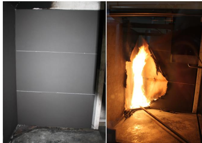
Rys. 6. Komora badawcza stanowiska badawczego wg PN-EN 13823 wraz zamontowaną próbką w postaci skóry naturalnej
