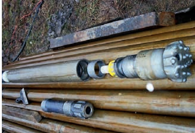
Ryc. 2. Podstawowe części dolnego młotka [10]
