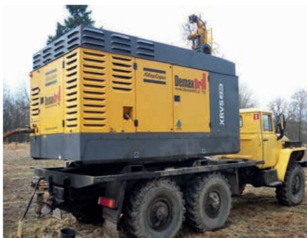
Ryc. 4. Kompresor powietrza – napędu dolnego młotka i płuczki wiertniczej [10]
