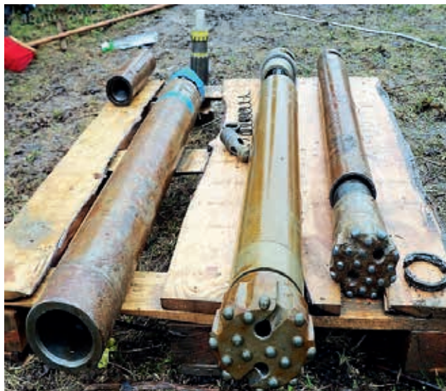
Ryc. 3. Zestaw dolnego młotka wraz ze świdrem płaskim [11]
