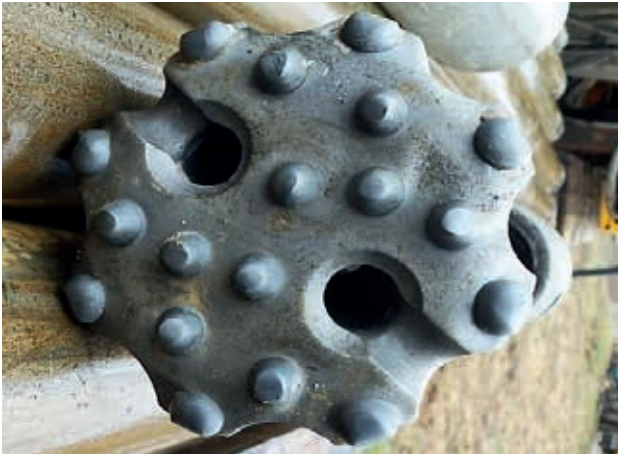
Ryc. 6. Czoło świdra wiertniczego do metody udarowo-obrotowej z kanałami dla przepływu powietrza [10]
