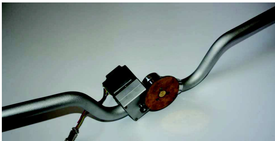
Rys. 4. Prototyp egzoszkieletu kończyny górnej Fig. 4. Prototype of upper limb exoskeleton
