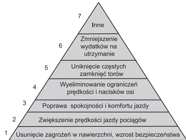
Rys. 1. Piramida celów wymian nawierzchni kolejowej [opracowanie własne]
