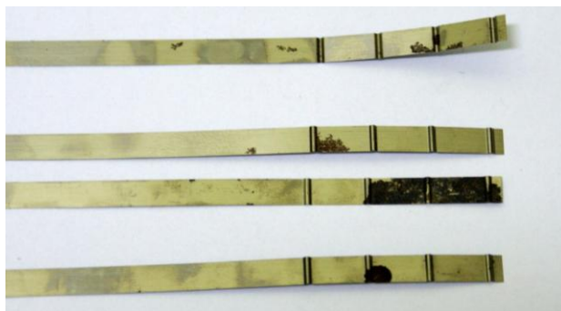
Zdjęcie nr 3 Korozja taśm zabezpieczających zapalnika DC-1 z NGP-76
