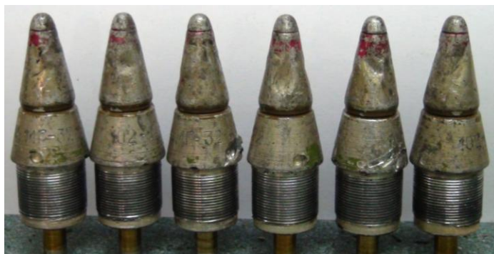
Zdj. 6. 30 mm nb. A-AK-630 z poc.odl.-burz. uzbr. w zap. MG-32 z wgniecieniami na korpusie czepca balistycznego zapalnika.
