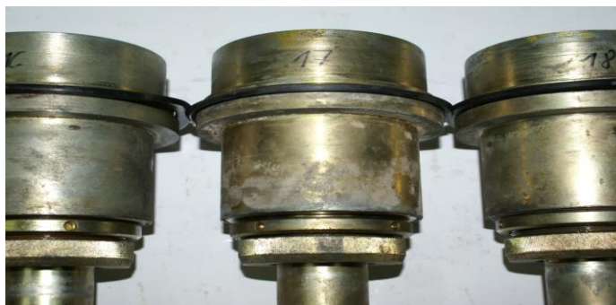
Zdj. 8. Korozja korpusu zapalnika „Rozwiązda”
