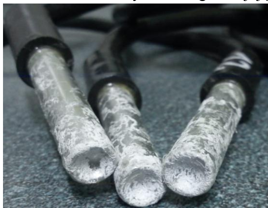
Zdj. 1. Zapalnik czasowy z długim lontem prochowym Bickforta
