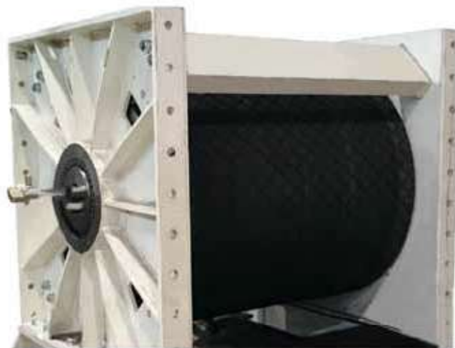
Rys. 5. Bezprzekładniowy układ napędowy górnego przenośnika taśmowego zabudowany w korpusie
