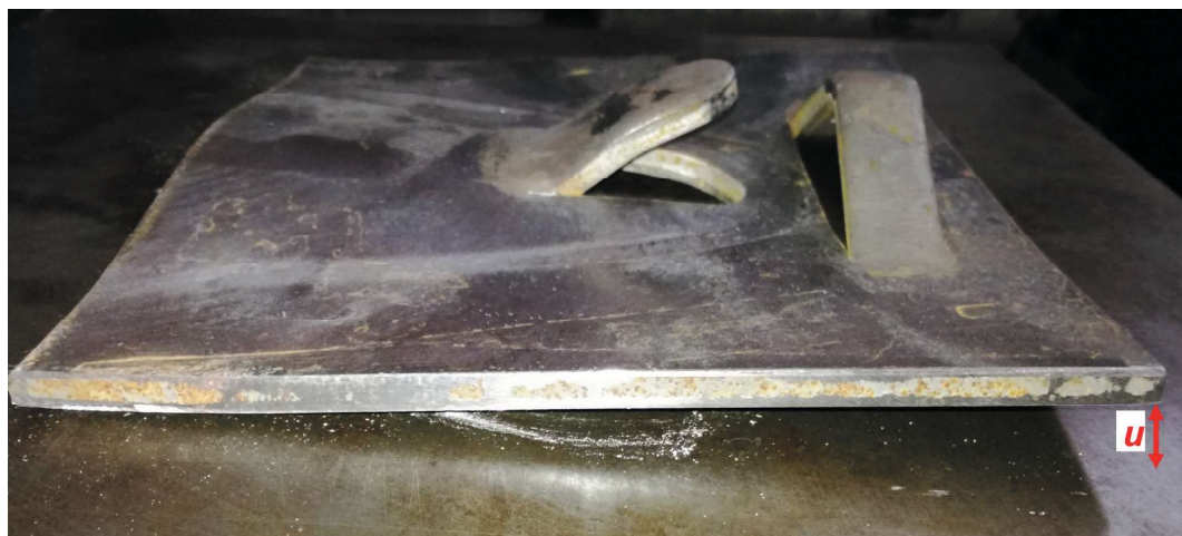
Rys. 5. Typowa deformacja stopy po badaniu Fig. 5. Typical post-test support base deformation
