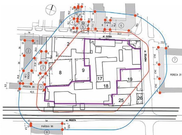
Rys. 7. Lokalizacja punktów pomiarowych zabudowy sąsiedniej
