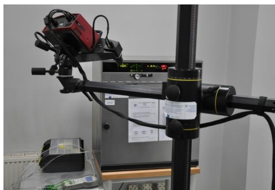
Rys. 1. Stanowisko do pomiaru rozszerzania gumy silikonowej w zależności od zmiany temperatury
