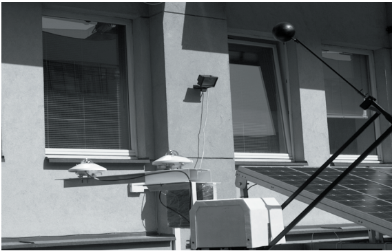
Rys.3 Zbudowany w laboratorium układ śledzący z przesłoną pyrometru do pomiaru globalnego i rozproszonego promieniowania.
