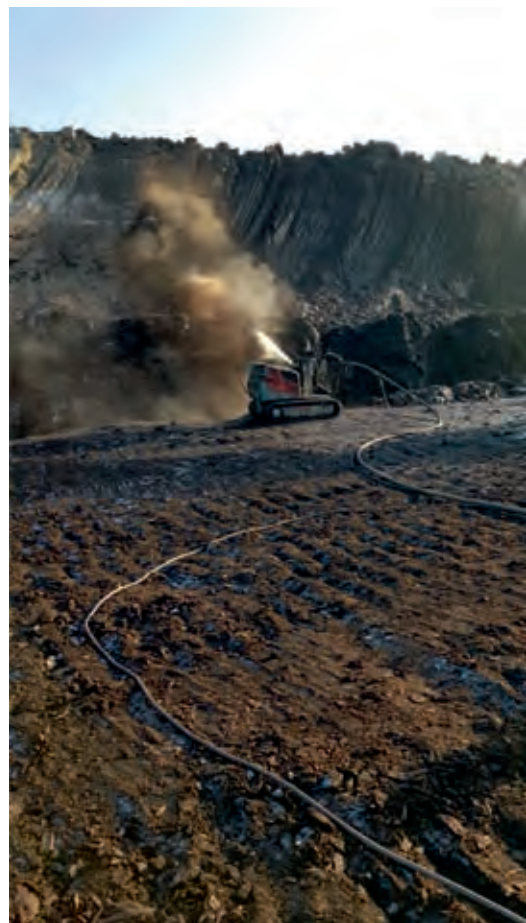
Rys. 5. Badania terenowe hydro-cięcia węgla, Kopalnia Węgla Brunatnego Bełchatów
