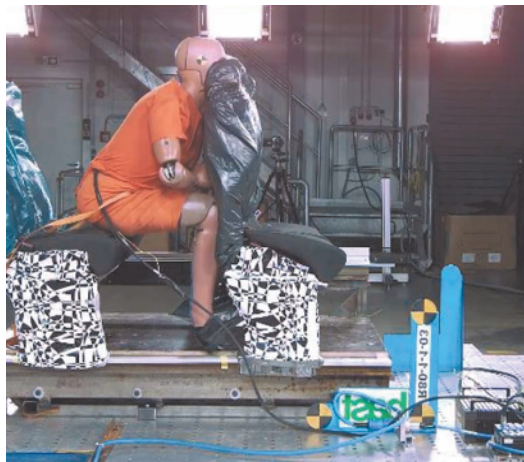
Ryc. 1. Manekin Hybrid III w czasie przeprowadzania badań; źródło: https://unece.org/ .
