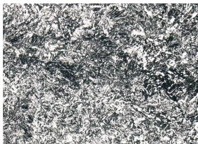
Rys. 1. Stal 38GSA – mikrostruktura martenzytu odpuszczania z bainitem oraz niewielkim udziałem troostytu
