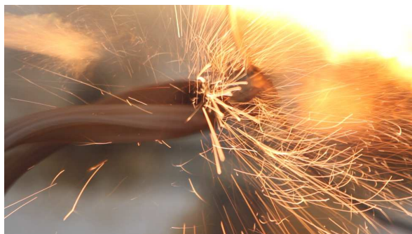
Rys. 6. Eksplozja liniowego ogranicznika przepięć
