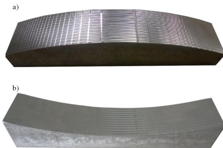
Rys. 6. Widok próbek po frezowaniu: a) próbka o powierzchni wypukłej, b) próbka o powierzchni wklęsłej Fig. 6. View to the milling samples: a) sample of the convex surface, b) sample of the concave surface
