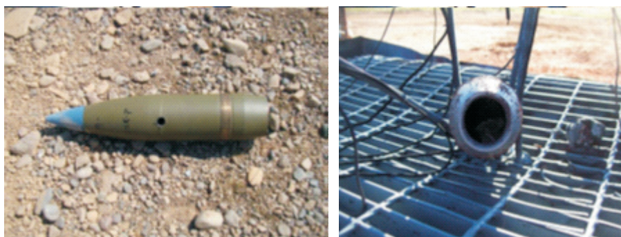
Rys. 3. Zdjęcia 155 mm pocisków artyleryjskich elaborowanych IMX-104 po testach: przestrzelenia pociskiem karabinowym (BI) i szybkiego ogrzewania (FH) — w pierwszym przypadku brak reakcji, w drugim spalanie
