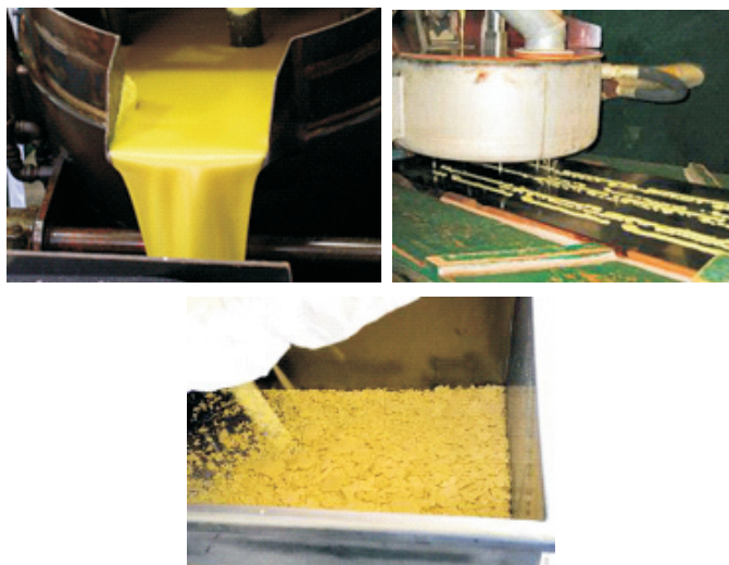
Rys. 2. Od lewej zdjęcia: odlewania ładunku IMX-101, granulowania IMX-101 i gotowego granulatu IMX-101
